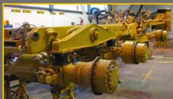
**2** Après son arrivée dans l'atelier de votre région, la machine est intégralement démontée, le châssis est inspecté dans les moindres détails par les équipes Bergerat Monnoyeur. La chaîne cinématique est reconditionnée pour retrouver toutes ses performances et sa fiabilité d'origine.
