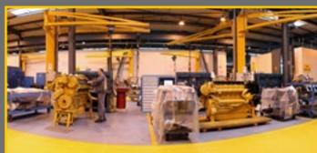
**4** Les composants majeurs y sont entièrement démontés et reconditionnés par nos techniciens spécialisés. Les pièces d'usure sont systématiquement remplacées et les cotes constructeur sont vérifiées. Les éléments sont réassemblés, testés au banc puis repeints avant d'être expédiés pour remontage sur la machine.
