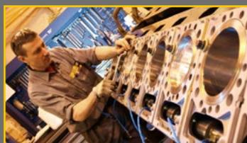
**3** L'ensemble du groupe motopropulseur est envoyé dans notre Centre Technique de Rénovation de Brie Comte Robert (77), spécialisé dans le reconditionnement industriel des composants mécaniques et hydrauliques. Le travail en poste et la spécialisation des techniciens permettent une fiabilité élevée et des délais de réparation restreints.
